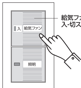
給気ファン・照明スイッチ
